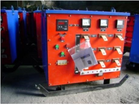
Трансформатор для прогрева бетона с воздушным принудительным охлаждением в однокорпусном исполнении с системой управления.
