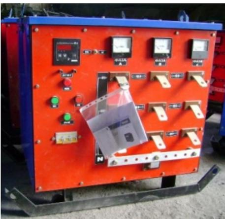
Трансформатор для прогрева бетона с воздушным принудительным охлаждением выполнен в однокорпусном исполнении на салазках.
